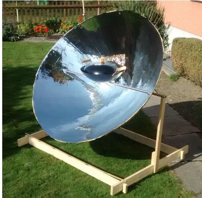
Es handelt sich hier um einen Sonnenkocher mit einem Parabolspiegel von etwas über 1 m<sup>2</sup> beschienener Fläche, was einer theoretischen Brutto-Leistung von ca. 1 kW entspricht. Die Herstellung bedarf mehrerer Materialien und ziemlichen handwerklichen Geschicks im Umgang mit diesen Materialien und Werkzeugen. Es muss exakt gearbeitet werden, daher sind alle Längenmasse dieser Bauanleitung in Millimeter angegeben.
