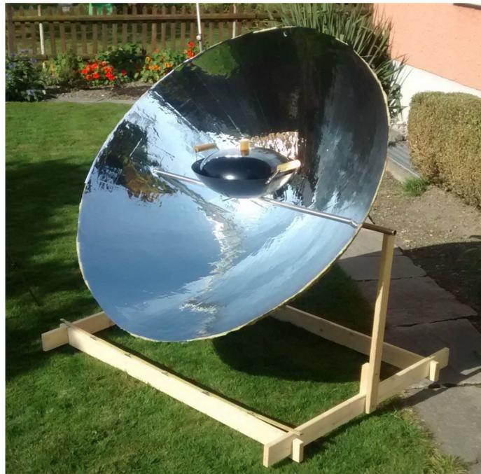
Trata-se de um fogão solar com um refletor parabólico de um pouco mais que 1 metro quadrado de captação, o que corresponde a uma potência bruta de aprox. 1kW. A construção do fogão exige vários materiais diferentes e habilidade manual com materiais e ferramentas. É importante trabalhar com precisão, por isso todas as medidas deste manual são anotadas em mm.
